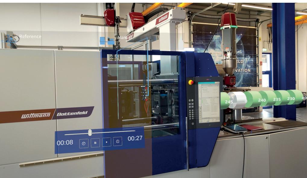
„Augmented Reality“ eingeblendet: Temperaturen der Schneckenzyylinder-Regelzonen von der Einzugszone bis zur Düse (beginnend rechts), sowie Animation des zukünftigen Programmablaufs © Wittmann Battenfeld
