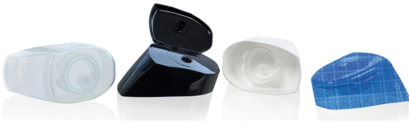
**Bild 1.** Die Flip-Top-Verschlüsse wurden in einem Werkzeug mit lasertexturtem Einsatz gespritzt, sodass sich ein unsichtbares digitales Wasserzeichen („HolyGrail“, rechts grafisch hervorgehoben) auf der Artikeloberfläche abformt © Männer/Barnes
